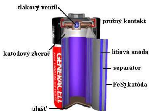
Obr.1 Schémy jednotlivých typov elektrických článkov
